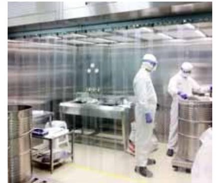
Des niveaux d'exposition admissibles plus bas créent souvent un risque additionnel pour le technicien, c'est pourquoi les cabines à flux descendant peuvent incorporer des logements de changement de filtre sécurisés. Ces logements peuvent autant se situer à l'intérieur de la cabine à flux descendant que sur un accès technique dédié.
